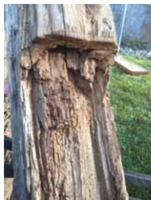
Ein kleiner Teil der ersetzten schadhaften tragenden Holzteile.
