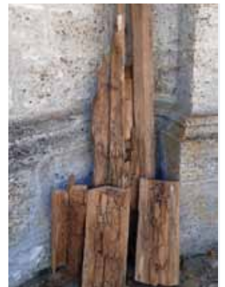
Ein kleiner Teil der ersetzten schadhaften tragenden Holzteile.
